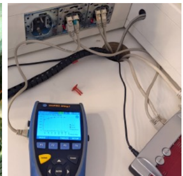
Jeder Link wurde mit einer RFC 2544 Messung protokolliert
